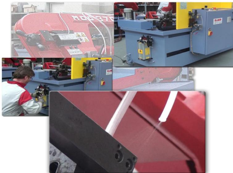
Использование модульной системы MiQueL в дополнение к увеличению срока службы инструмента (благодаря уменьшению трения между инструментом и заготовкой, а также отвода тепла от механической обработки), использует биоразлагаемые масла, а значит устраняет проблему утилизации эмульсий и в то же время уменьшает сильное воздействие на окружающую среду.
