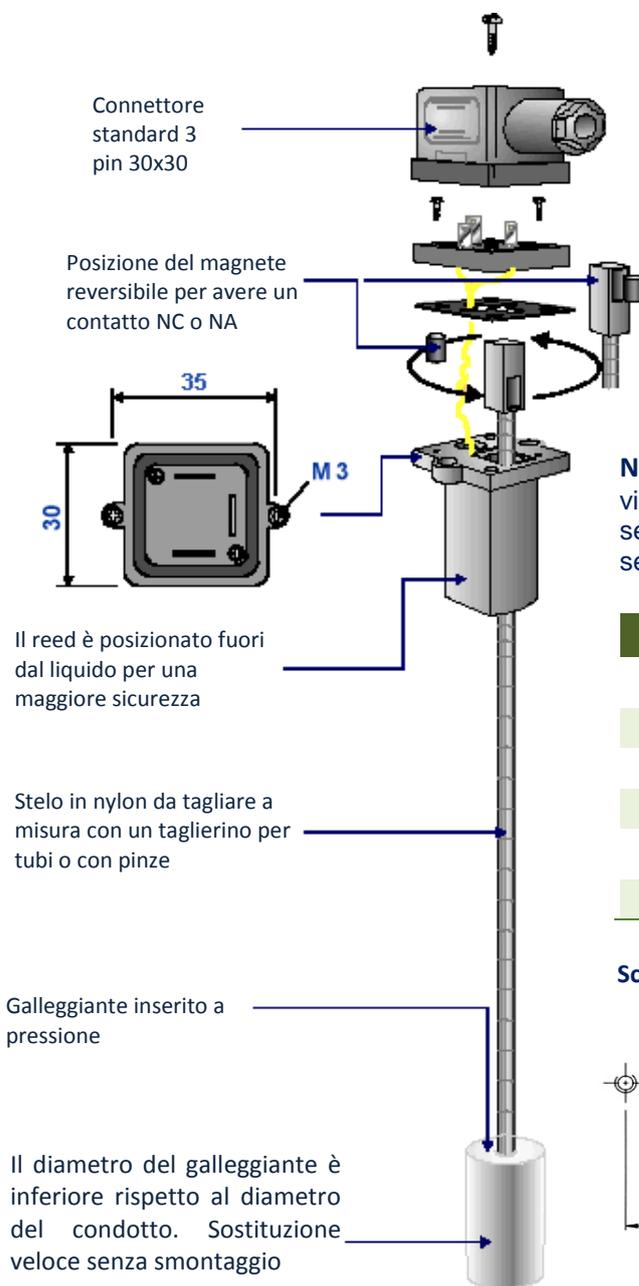
**Note:** Il sensore di livello Samba viene fornito con il galleggiante ma senza connettore, da ordinare separatamente.
