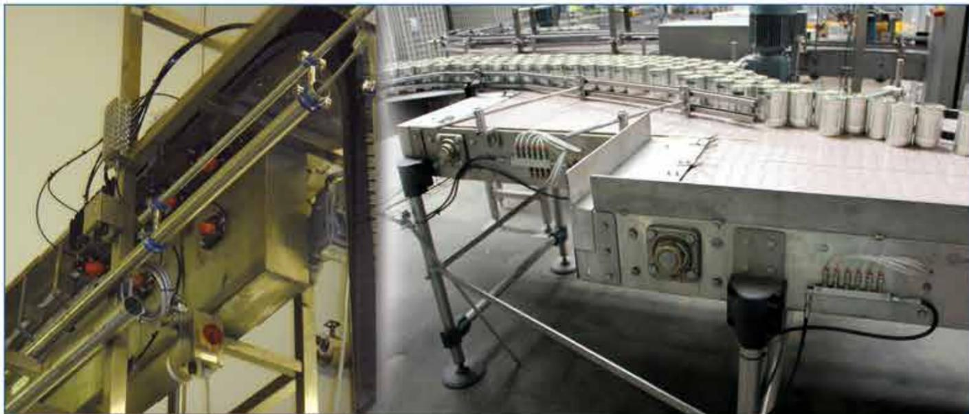
lubrification est indispensable au bon fonctionnement des machines, d'autant plus lorsqu'elles travaillent dans des conditions ambiantes difficiles comme le secteur alimentaire. L'installation d'un système de lubrification automatique permet de réduire les temps d'arrêt, de contrôler la consommation de lubrifiant et d'augmenter la durée de vie des roulements, des chaînes et des engrenages.
