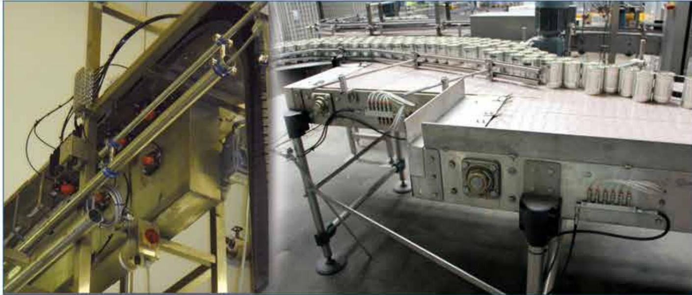
Die Anwendung von Schmiersystemen ist für den korrekten Betrieb der Maschinen unabdingbar, auch weil diese unter schwierigen Bedingungen, wie beispielsweise in der Lebensmittelbranche, arbeiten. Die Installation eines automatischen Schmiersystems ermöglicht die Reduzierung von Maschinenstillständen, die Kontrolle des Schmiermittelverbrauchs und die Erhöhung der Lebensdauer von Lagern, Ketten und Zahnrädern.
