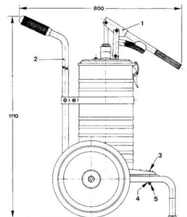
Platzbedarf vorn, einschließlich der beiden Wagenräder, 460 mm
