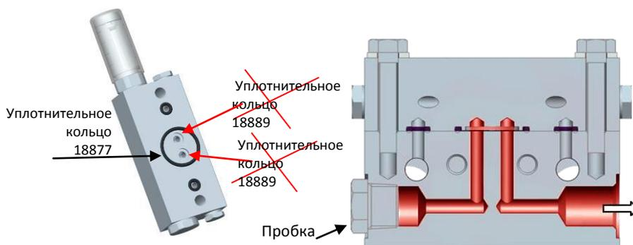
**ВАЖНО** Отдельно заказывается заглушка, код 0926001 (UNI-ISO) или с кодом 0850304 (NPTF) для закрытия неиспользуемого выхода.
