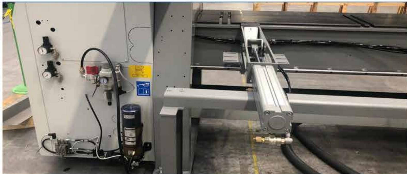
Die Anwendung von Schmiersystemen ist für den korrekten Betrieb der Maschine unabdingbar, auch weil diese unter schwierigen Bedingungen, wie beispielsweise in der Holz- und Papierindustrie arbeiten. Die Installation eines automatischen Schmiersystems ermöglicht die Reduzierung von Maschinenstillständen, die Kontrolle des Schmiermittelverbrauchs und die Erhöhung der Lebensdauer von Lagern, Ketten und Zahnrädern.
