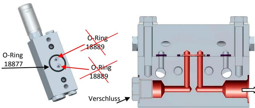
**WICHTIG** Der Verschluss ist separat zu bestellen, Artikelnr. 0926001 (UNI-ISO) oder Artikelnr. 0850304 (NPTF), um den nicht verwendeten Ausgang zu verschließen.
