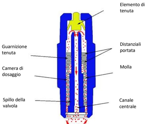
Nel momento in cui cessa la pressione dell'olio sulla linea di alimentazione, per effetto della contropressione si chiude l'ingresso del lubrificante tramite l'elemento di tenuta che con l'aiuto della molla, spinge in alto l'anello e la guarnizione. Il lubrificante presente sopra l'anello fluisce attraverso il canale centrale, esce dal basso e viene risucchiato nella camera di dosaggio. In questo modo si riempie la camera per il ciclo successivo.
