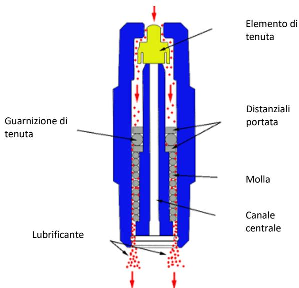
L'ingresso del lubrificante in pressione spinge verso il basso l'anello e la guarnizione. Questo movimento permette lo svuotamento della camera di dosaggio.
