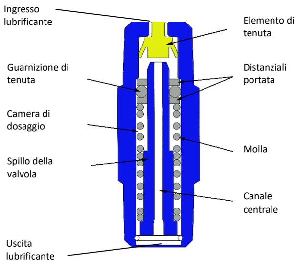
Aumenta la pressione della linea. L'olio in pressione vince la contropressione presente sulla linea in uscita, e spinge in basso la guarnizione, che va a chiudere il canale centrale. Comincia ad entrare il lubrificante all'interno della valvola, trafile ai lati della guarnizione di testa.
