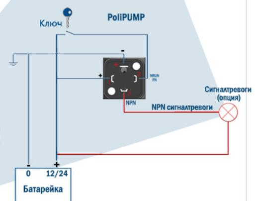
При подключении сигнала NRUN к ключу зажигания транспортного средства, циклы смазки происходят только в том случае, когда машина включена. При выключении машины - насос прекращает цикл смазки. При включении - цикл возобновляется с того места, где был прерван (в режиме ожидания или смазки).
