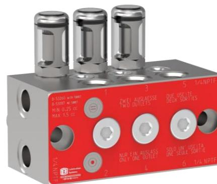
Gli alimentatori vengono normalmente forniti con le due uscite separate, salvo diversamente indicato in ordine. Se si desidera utilizzare una sola uscita basterà sostituire il disco di tenuta X cod. **622077** con il disco di tenuta Y cod. **622076**. (vedi disegno). In questo caso la portata massima per ogni ciclo completo passa da 0,25 ÷ 1,5 cm<sup>3</sup> a 0,5 ÷ 3 cm<sup>3</sup>.
