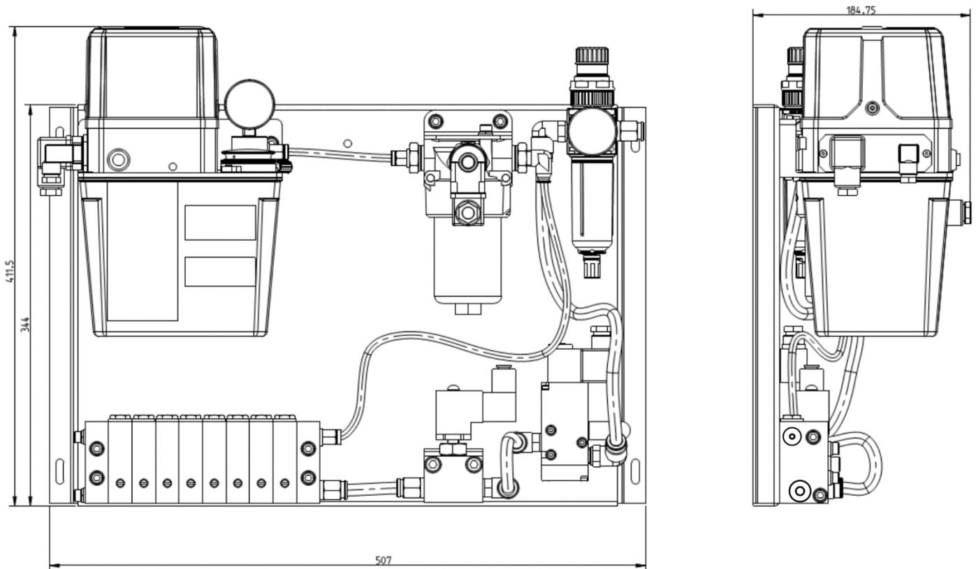
Im Vergleich zu einem Standard-VIP4-System ist diese Einheit eine Komplettlösung mit Steuerung (über den **automatischen SMART3-Controller**), Luftregulierung, Ölfiltrierung, Luftdruck- und Durchflusskontrolle.
