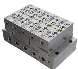
Gracias a su **diseño modular**, el sistema puede ampliarse fácilmente y la sustitución de los elementos dosificadores puede realizarse sin necesidad de desmontar los tubos, lo cual garantiza unos reducidos costes de mantenimiento. El diseño modular de los dosificadores permite asimismo agrupar los puntos de lubricación según los requisitos de la instalación.
