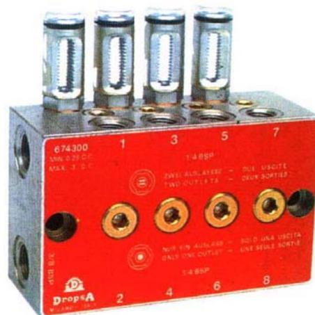
Se si desidera utilizzare una sola uscita basterà sostituire il disco di tenuta X cod. **622077** con il disco di tenuta Y cod. **622076** (vedi disegno). In questo caso la portata massima per ogni ciclo completo passa da 0,25 ÷ 3 cm<sup>3</sup> a 0,5 ÷ 6 cm<sup>3</sup>.
