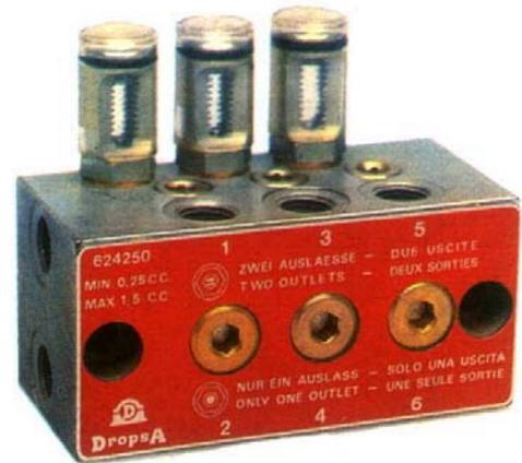
Gli alimentatori vengono normalmente forniti con le due uscite separate, salvo diversamente indicato in ordine. Se si desidera utilizzare una sola uscita basterà sostituire il disco di tenuta X cod. 622077 con il disco di tenuta Y cod. 622076. (vedi disegno). In questo caso la portata massima per ogni ciclo completo passa da 0,25 ÷ 1,5 cm<sup>3</sup> a 0,5 ÷ 3 cm<sup>3</sup>.
