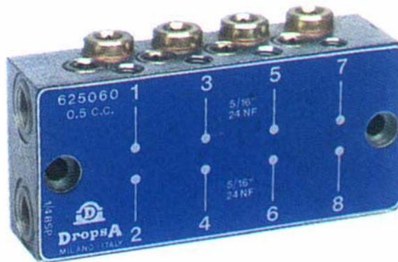
Le due uscite di ogni elemento dosatore vanno in ogni caso utilizzate. Se si desidera utilizzare una sola uscita ci si deve servire della giunzione a ponte **cod 622030** poiché l'altra uscita non può essere tappata. La giunzione unisce la portata delle due uscite in una sola e di conseguenza, la portata per ogni elemento raddoppia. In questo caso la portata massima per ogni ciclo completo passa per l' APF05 da 0,5 ÷ 1 cm<sup>3</sup> e per l'APF1 1 ÷ 2 cm<sup>3</sup>.
