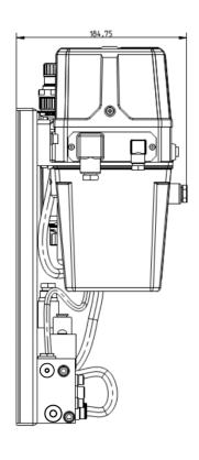
По сравнению со стандартной системой VIP4, эта установка представляет собой комплексное решение, оснащенное системой управления (посредством автоматического контроллера SMART3), регулировки воздуха, фильтрации масла, регулировки давления воздуха и контроля расхода.
