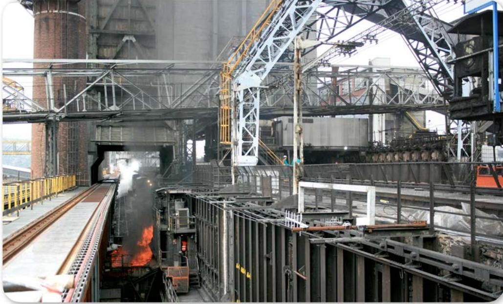
Les fours à coke servent à transformer le charbon en coke. Pour ce faire, la voiture de charge place le charbon dans le four. Une fois le charbon chauffé à de hautes températures, la voiture poussoir déplace le charbon dans la voiture de transfert.
