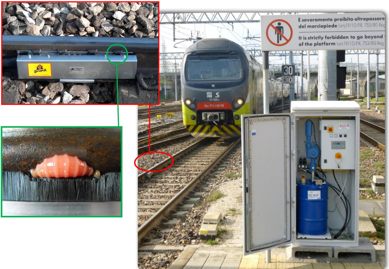
**Il sistema Track-Lube è stato concepito per la lubrificazione del fianco attivo della rotaia su tratte tortuose.**
