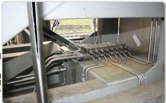
Передаточная тележка. Роликовые подшипники 4-точковая смазочная секция.
