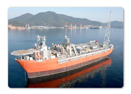
转塔是整个油船的主要组成部分,也是油船在系泊后能旋转的轴心点.大部分的转塔用的轴承高达 8M, 是为了快速地提取油,油船建造商不得不提高到 8 米.超过 8 米直径的轴承很难获得而且价格昂贵.因为使用近 20 米直径的圆柱,新技术应运而生.圆柱由转向架固定.转向架由润滑板在径向转轮和轴流向转轮进行润滑.
