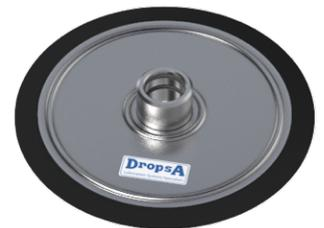
Es ist ratsam, immer die Fettfolgeplatte zu verwenden. Dies ist besonders wichtig, wenn die Temperatur niedrig ist und wenn Fett mit hoher Viskosität verwendet wird. Durch den von der Pumpe erzeugten Unterdruck wird die Platte durch den atmosphärischen Druck in Richtung Fassboden gezogen. Es drückt das Fett in die Pumpe und vermeidet Lufteinschlüsse. Es entfernt auch das an den Wänden verbliebene Fett bis zum Boden der Fässer.
