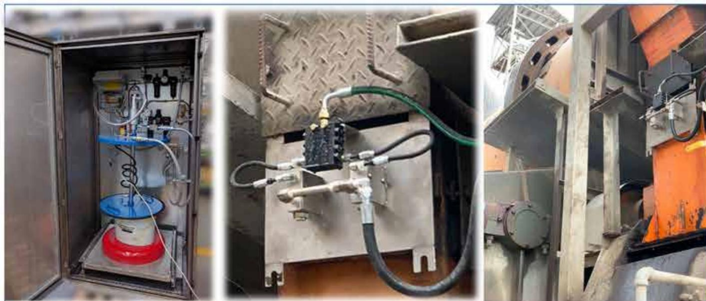
La utilización de sistemas de lubricación es indispensable para el correcto funcionamiento de la maquinaria y, todavía más, cuando estas trabajan en condiciones ambientales difíciles como las de las cementeras y procesamiento de materias primas. La instalación de un sistema de lubricación automático permite reducir los periodos de parada de la máquina, controlar el consumo de lubricante y aumentar la vida útil de rodamientos, cadenas y engranajes.
