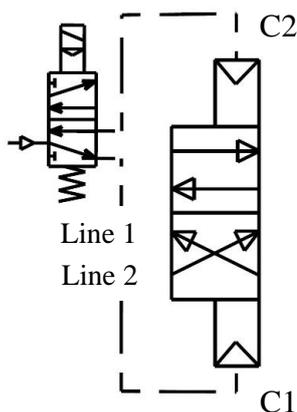
Pressurizando o cilindro C1 faz-se a comutação da Linha 2 para a Linha 1.
