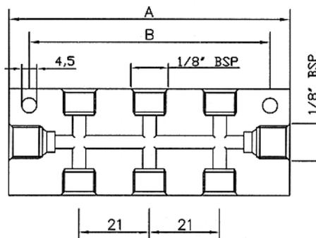
Pour montage avec vannes de 0,03 à 0,50 cm<sup>3</sup>/min.
