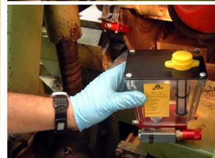
*Grip* vereint die Vorteile der Luft- / Ölschmierung mit der Möglichkeit, die Pumpe an den Maschinen schnell einzusetzen, ohne dass Befestigungsarbeiten nötig sind.
