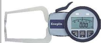
eine übersichtlich gestaltete LCD Anzeige aus, die eine sichere Messwerterkennung erleichtert. Die in den verschiedenen Programmen ermittelten Messwerte können, je nach Anforderung, als Absolut-, Relativ- und Toleranzmesswert angezeigt werden. Die Werkstatttauglichkeit wird durch die Schutzart IP67 garantiert. Zur statistischen Qualitätssicherung können die Geräte über zwei Schnittstellen (USB oder Mitutoyo) an PCs oder Auswertegeräten von Mitutoyo angeschlossen werden. (si)
