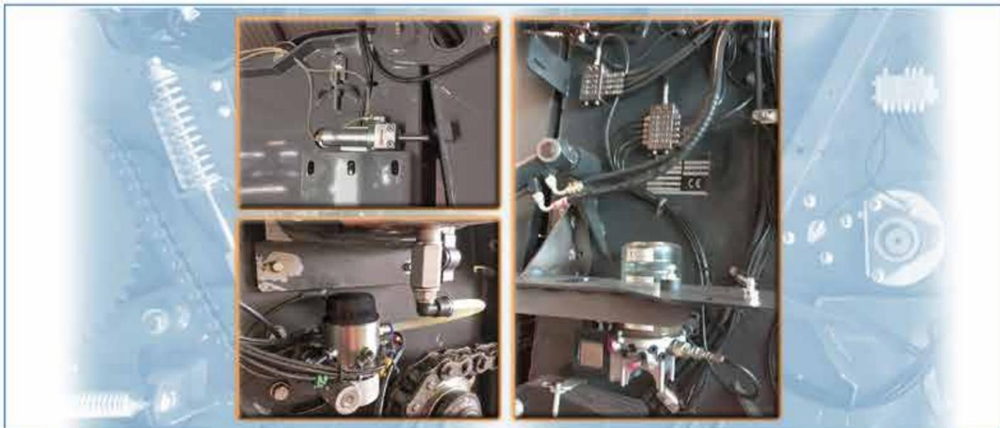
La utilización de sistemas de lubricación es indispensable para el correcto funcionamiento de las máquinas y todavía más cuando estas trabajan en condiciones ambientales difíciles como las del sector agrario. La instalación de un sistema de lubricación automático permite reducir los periodos de parada de la máquina, controlar el consumo de lubricante y aumentar la vida de rodamientos, cadenas y engranajes.
