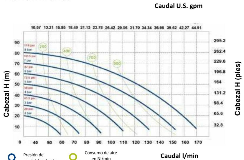
Las curvas y los valores de rendimiento se refieren a bombas con succión sumergida y una salida de suministro libre con agua a 20 °C, y varían según el material de construcción.
