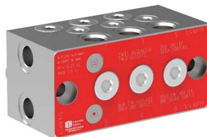
Se si desidera utilizzare una sola uscita basterà sostituire il disco di tenuta X cod. **622077** con il disco di tenuta Y cod. **622076** (vedi disegno). In questo caso la portata massima per ogni ciclo completo passa da 1,5 cm<sup>3</sup> a 3 cm<sup>3</sup>.
