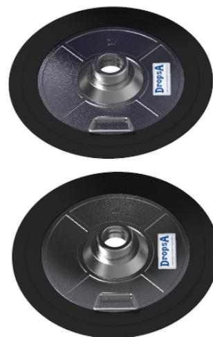
Si consiglia di utilizzare sempre il disco pressatore, è molto importante con basse temperature e quando si utilizza grasso ad alta viscosità. A causa della depressione creata dalla pompa, il disco viene attratto verso il fondo del fusto dalla pressione atmosferica. Spinge il grasso nella pompa ed evita cavità di aria. Rimuove anche il grasso rimasto sulle pareti, fino alla parte inferiore dei fusti.
