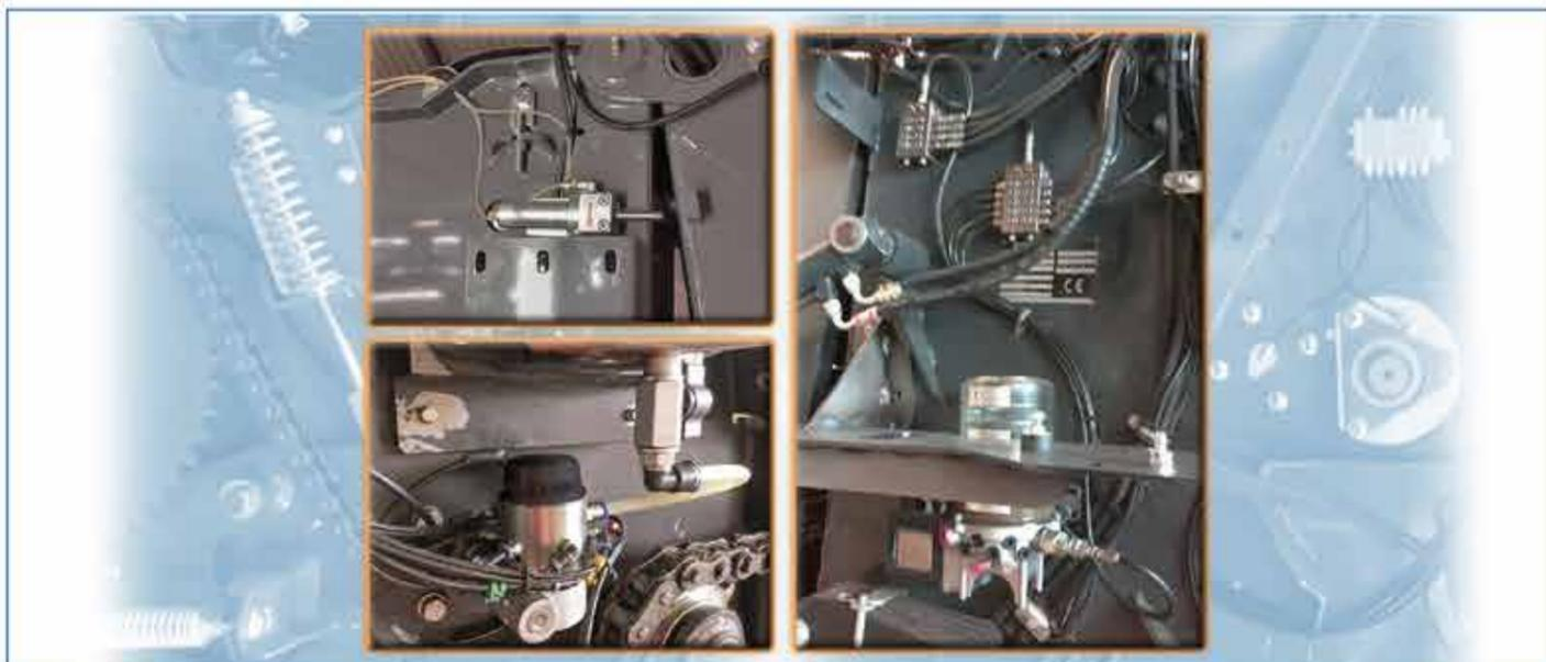
L'utilizzo di sistemi di lubrificazione è indispensabile per il corretto funzionamento delle macchine ancor di più quando queste lavorano in condizioni ambientali difficili come quelle del settore agricolo. L'installazione di un sistema di lubrificazione automatico consente di ridurre i fermi macchina, controllare il consumo di lubrificante e aumentare la vita di cuscinetti, catene e ingranaggi.
