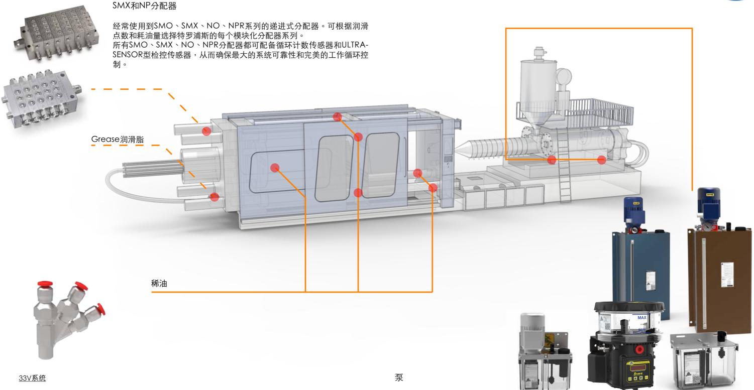
该系统是Dropsa 最近研发出来的容积式注油器技术。此技术不受粘度,温度和压力的影响,提供精确的润滑剂,并且有失效保护的功能。此分配阀跟其他实惠的电动泵一起可以组成一个非常高效的系统。我们的快插系统更进一步节约了安装成本。
