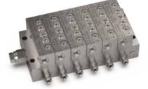
该模块化系统由两个主要部件构成:底座和分配器元件。消除了桥式接头,取而代之的是桥式计量元件,可将流量传输到组块中。此外,分配器的装配原理使其可以对润滑点进行分组。组装好的底座可以在无需模块分配器的情况下进行安装和连接,以便最方便地接触到管道。这之后再安装元件。该系统可以轻松扩展,其模块化的概念使组件更换成本非常低。
