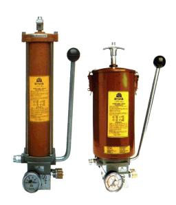
Accionando la palanca de mando se suministra presión a una de las dos líneas de alimentación. Al alcanzar la presión correspondiente, configurada a través de las válvulas de regulación del inversor, se produce la inversión de presurización de las líneas, que queda patente mediante:
