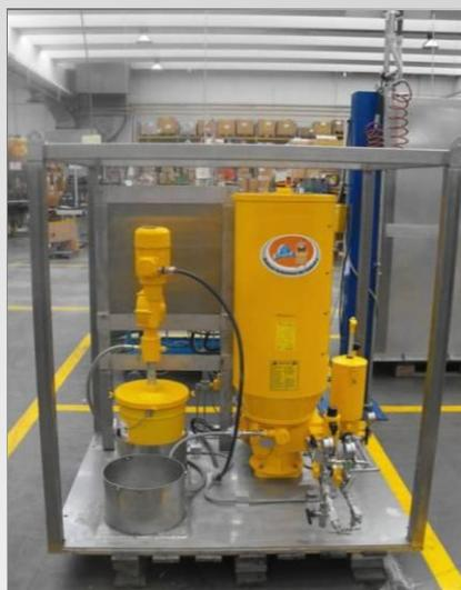
Pompa SUMO 100 kg con rivestimento personalizzato giallo montata su assieme in acciaio 316 che incorpora un sistema manuale di controllo PLC e pompa elettrica da fusto per il riempimento.
