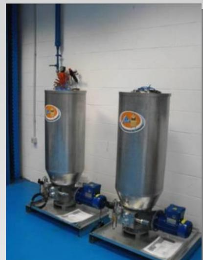
SUMO ATEX 316: versione con pompanti, ripartitori di pressione e serbatoio in acciaio Inox 316.
