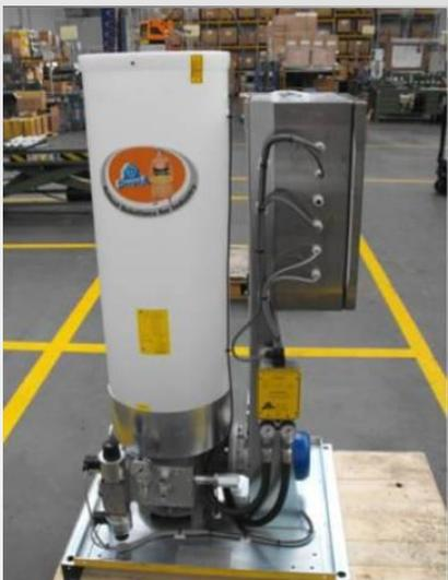
Pompa SUMO con serbatoio semi-trasparente pressostato di fine linea e pannello di controllo in cassetta INOX installati su di un pallet standard.
