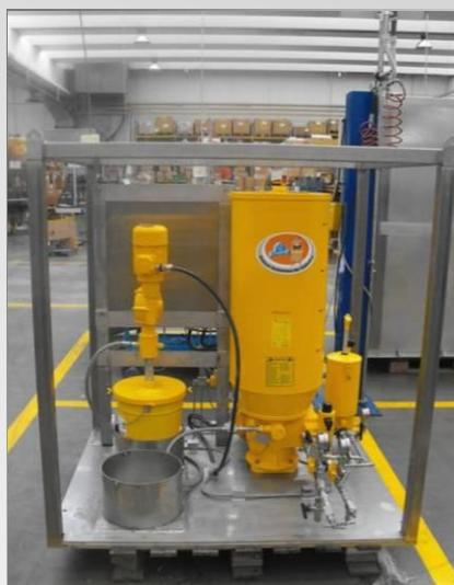
100 Kg SUMO Pumpe mit einem kundenspezifischen gelben Anstrich auf einem Gestell aus rostfreiem 316er Stahl, mit SPS-Steuerung, manueller Reservepumpe und zur sicheren Befüllen eine elektrische
