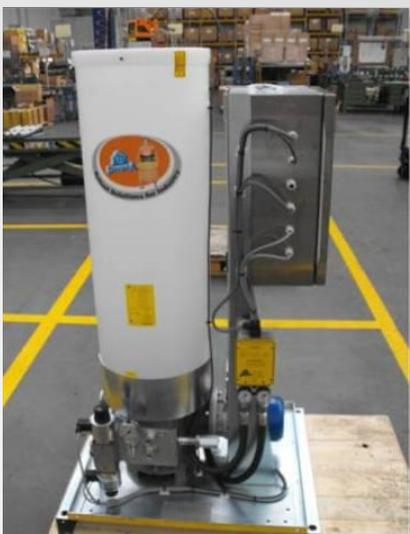
SUMO Pumpe halbtransparenter Behälter mit am Ende der Leitung installiertem Druckschalter und Bedienelement in Edelstahlbox auf der Standard-Palette.
