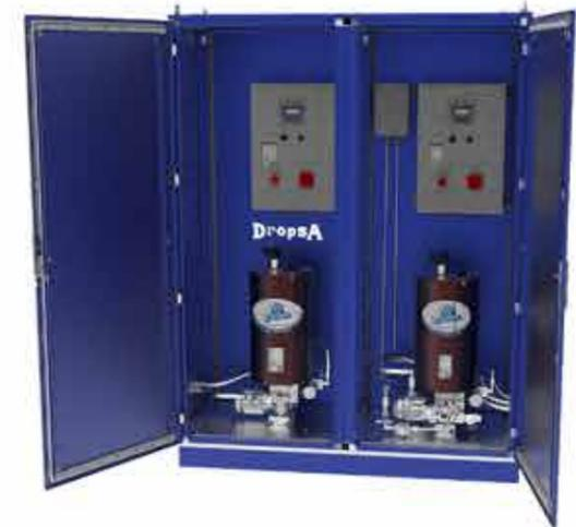
Die Luft-/Ölschmierung besteht aus einem ständig in Bewegung befindlichen Luftstrom, der das Öl zum Schmierpunkt befördert und gleichzeitig das System kühlt. Das in den Luftstrom in regelmäßigen Abständen eingespritzte Öl bedeckt die zu schmierenden Oberflächen, wodurch Verschleiß und Reibung reduziert werden.
