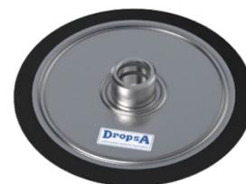
建议始终使用从动盘，在温度较低和使用高粘度干油的情况下，这一点至关重要。由于泵产生的压降，从动盘会在大气压力的作用下被引向油桶底部。
