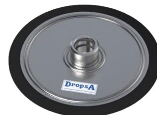
Es recomendable utilizar siempre el disco prensador, es muy importante cuando la temperatura es baja y cuando se utiliza grasa de alta viscosidad. Debido a la depresión creada por la bomba, el disco es atraído hacia la parte inferior del tambor por la presión atmosférica. Empuja la grasa hacia la bomba y evita las cavidades de aire. También elimina la grasa que queda en las paredes, hasta el fondo de los tambores.
