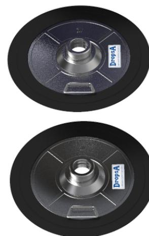
Il est conseillé d'utiliser toujours la plaque de soutien, ce qui est très importante lorsque la température est basse et lorsque de la graisse à haute viscosité est utilisée. En raison de la dépression créée par la pompe, la plaque est attirée vers le fond du tambour par la pression atmosphérique. Il pousse la graisse dans la pompe et évite les cavités d'air.
