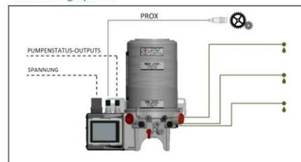
Mit dieser Konfiguration besteht die Schmierphase aus **einem einzigen Zyklus** (Anzahl der Zyklen: 1), der sich **alle 6 min 00 s** (Zeitintervall: 6 m 00 s) **oder alle 10 Impulssignale** (Impulsintervall: 10), die am Eingang 1 eingehen (Eingang 1: Impulszählung), aktiviert. Die Schmierphase endet mit Erreichen von 2 kompletten Hüben des Pumpenmotors (Impulse/Zyklushübe: 2).
