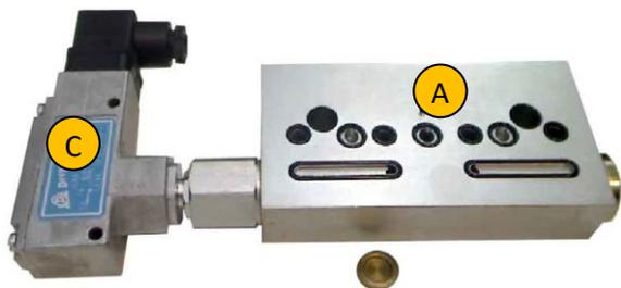
Un microrupteur avec contact de commutation est commandé par une tige articulée, solidaire du piston de l'élément de dosage. Ce dispositif convient pour le contrôle du cycle de lubrification à intervalles prédéfinis.
