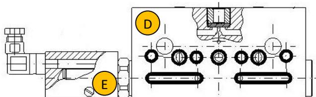
Un aimant permanent appliqué sur le piston actionne un contact « Reed » qui, lorsqu'il est connecté à un compteur électronique, peut détecter jusqu'à 500 mouvements par minute. Le contact « Reed » est inséré dans un contenant scellé et peut être facilement remplacé. L'élément de dosage complet de ce dispositif, s'il est fixé à une masse métallique, doit être espacé d'au moins 10 mm (0,39 in.). Il est préférable de l'appliquer avec le dispositif vers le haut et les sorties vers le bas.
