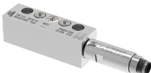
UltraSensor 2 è stato progettato per sostituire i sistemi con sensori induttivi di prossimità, micro-interruttori meccanici, e i contatti magnetici che monitorano il movimento dei pistoni all'interno degli elementi dosatori dei sistemi progressivi. Il sensore è un accessorio da avvitare (lateralmente al dosatore), senza bisogno di modificare in alcun modo il dosatore.
