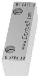
L'elemento by-pass ha le stesse dimensioni di un elemento dosatore, ma senza pistone interno, pertanto senza dosaggio. La sua funzione è di creare una posizione di riserva dove poter installare in seguito una valvola dosatrice per aumentare il numero di uscite.
