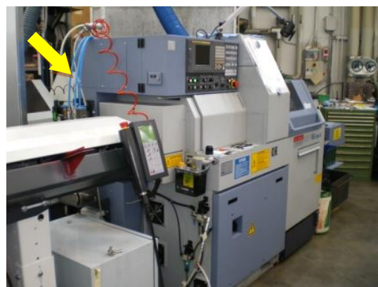
Perforación con brocas de cañón sobre el taladro
